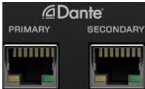
RJ 45（Ethernet）ポートでプライマリおよびセカンダリの Dante® 接続が可能。入出力のオーディオチャンネル数はサンプルレートに依存しますのでご注意ください。セカンダリ Dante®ポートは、プライマリ Dante®ポートとミラーリングされ、リダンダントポートとして機能しますが、独立したチャンネル数を提供するものではありません。
