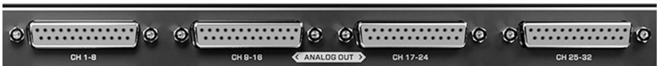
32 系統のラインオーディオ出力を 4×DC-coupled DB25 コネクタ（TASCAM ピン互換）で装備しています。
