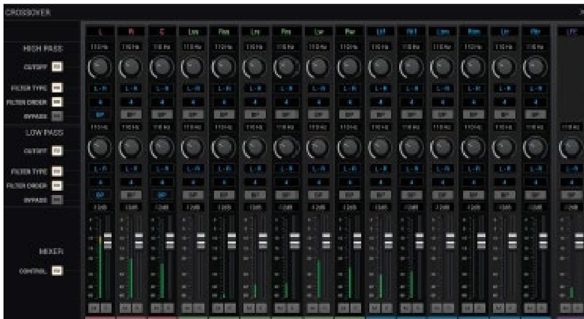
このミキサー画面は、LFE チャンネル設定(LFE クロスオーバーボタン)から利用できます。LFE チャンネルを経由して、サラウンド/オーバーヘッドチャンネルの低域をモニターするための低音マネージメント設定が可能です。各チャンネルは、選択されているフォーマットとパスオーダーに従った色分けとラベル付けています。
