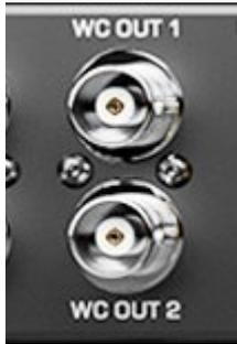
外部機器を Galaxy 32 Synergy Core に同期させるためのワードクロック出力（BNC コネクタ）を 2 系統装備しています。
