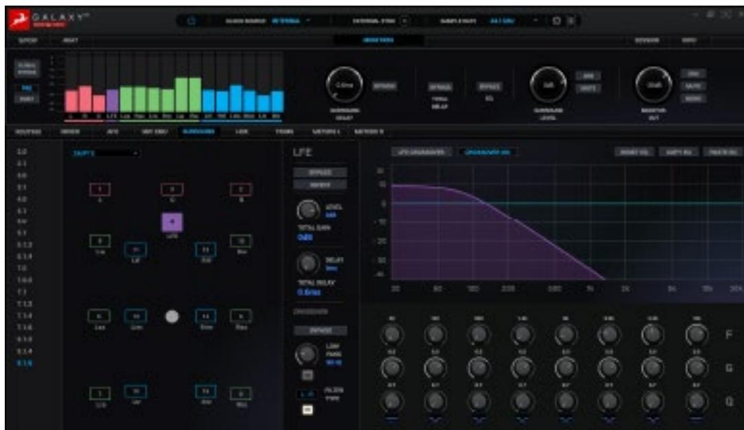
LFEチャンネルを選択すると、クロスオーバー設定がEQの上に表示されます。更にチャンネルのクロスオーバーフィルター設定は、LFEチャンネルのローパスフィルターに切り替わります。
