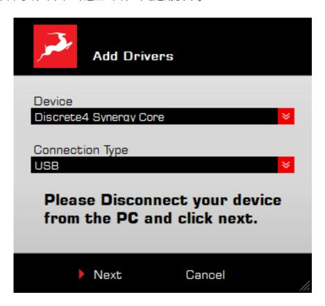
ドロップダウンメニューからデバイスと接続タイプを選択し、コンピュータからデバイスを取り外し、「Next」をクリックしてドライバの再インストールを実行してください。
