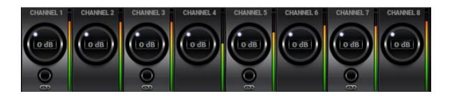
このタブには、編集可能なテキストラベル、ゲイン調整ノブ、リンクボタン、シグナル強度メーターを備えた 8 つの ADAT デジタルオーディオ入力のコントロールが含まれています。 すべてのチャンネルで使用可能な入力ゲインの範囲は -6dB  $\sim$  12dB です。 ADAT は S/MUX で動作します。
