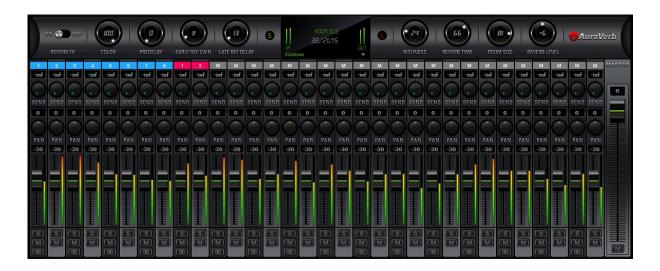
ミキサータブには、4 つの 32 チャンネルのソフトウェアミキサーがあります。各チャンネルには、Pan、Volume、Solo、Link(奇数チャンネルの場合)のコントロールとメーター機能が装備されています。マスターチャンネルにはボリュームとミュートのコントロールがあります。
