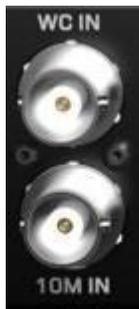
1 вход Word Clock и 1 вход Atomic Clock на разъемах BNC для синхронизации с внешними Clock источниками.
