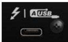
Порт Thunderbolt™ 3 / USB 2.0 Type-C обеспечивает подключение к PC/Mac.
