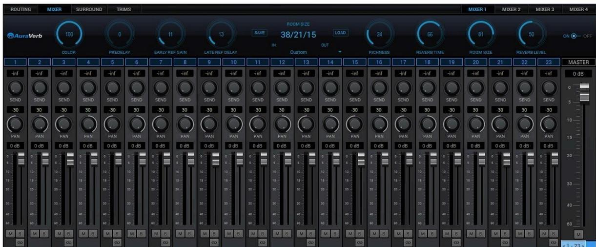
На вкладке Mixer расположены четыре 32-канальных виртуальных микшера. Каждый канал оснащен регуляторами Pan, Volume, Solo и Link (на нечетных каналах), а также замером. Мастер-канал имеет регуляторы громкости и отключения звука.
