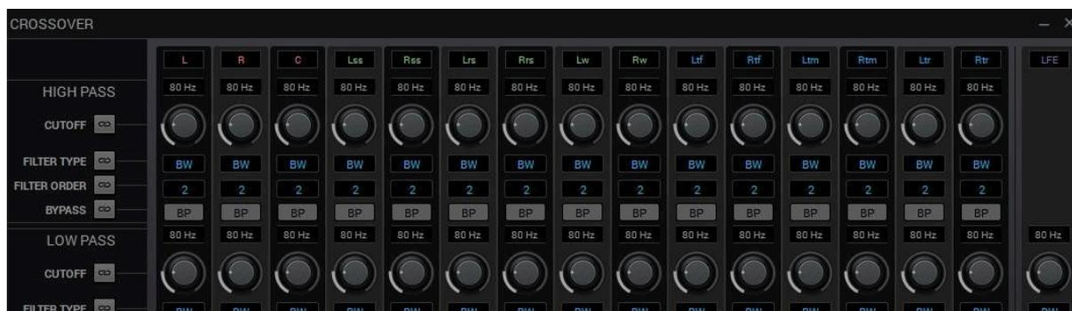
Вышеуказанный микшер доступен через кнопку Bass Management Mixer на вкладке Monitoring. Он содержит все настройки управления басами, позволяющие контролировать низкочастотное содержимое каналов объемного/верхнего звучания через канал LFE. Каждый канал имеет маркировку и цветовое кодирование в соответствии с выбранным форматом и порядком прохождения.
