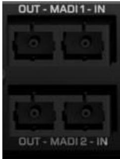
Входы/выходы MADI, передающие цифровое аудио по оптоволоконному кабелю с SC-разъемами на обоих концах. Для каждого разъема действуют стандартные ограничения на передачу звука MADI:
