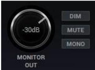
Monitor output controls [элементы управления выводом монитора] - применяются к физическому выходу стереомонитора мастеринг-класса на задней панели интерфейса.
