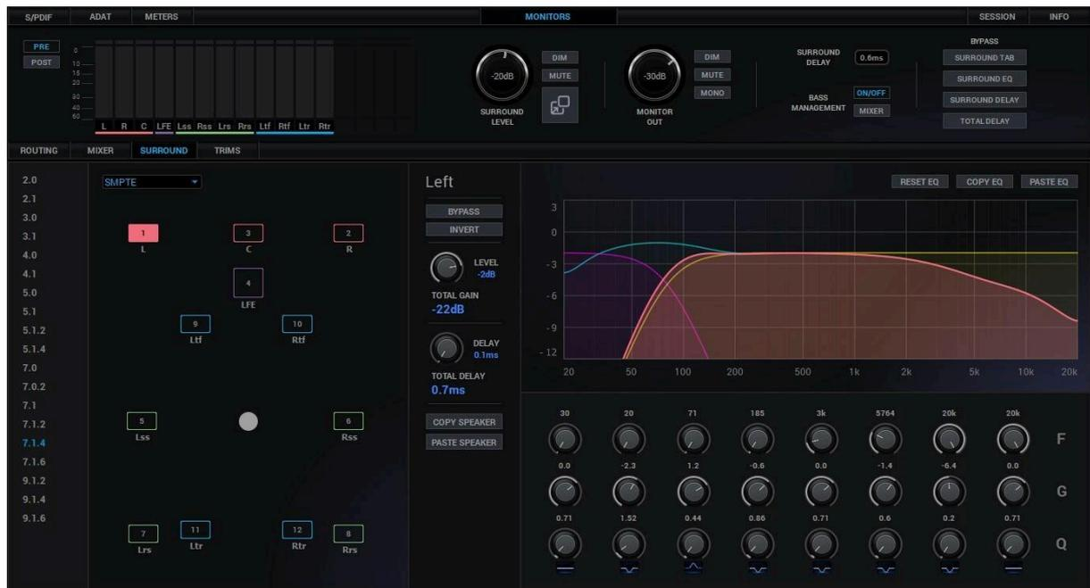
Эта вкладка панели управления предоставляет функции управления мониторингом и обработки калибровки динамиков для 16 каналов объемного или иммерсивного звука. Поддерживаются форматы от стерео до 9.1.6 Dolby Atmos, при этом сохраняется возможность настройки в пределах 16-канального лимита для любых нестандартных требований к настройкам.
